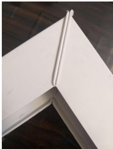
شکل 1- نمونه جوش صحیح با بیرون زدگی مناسب مواد مذاب پروفیل در اثر پرس
